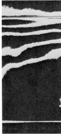
Bild 7. Äquidensiten in Schwarz-Weiss-Darstellung zu Bild 8b gehörend. Temperatur während der Aushärtung oben, 45°C; unten, 30°C; Aushärtedauer 24 h.
